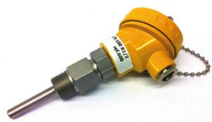
Sonda temperatura inmersión PT-100-3H 4-20 mA, longitud 50mm + vaina 1/2\"/>
